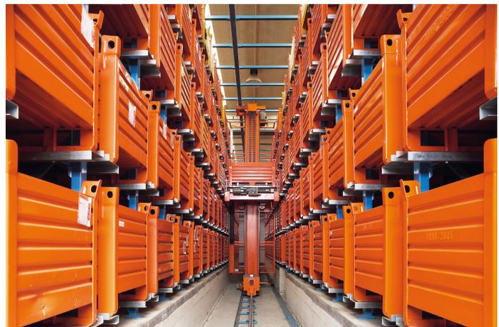
Vollständig fest verbaute Automatisierung: Automatisiertes Lager- und Bereitstellungssystem (AS/RS), automatische Sortierung
